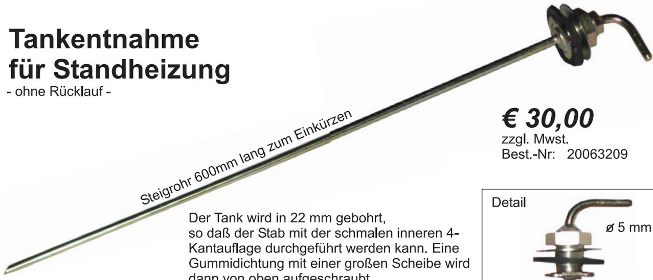
Der Tank wird in 22 mm gebohrt, so daß der Stab mit der schmalen inneren 4-Kantauflage durchgeführt werden kann. Eine Gummidichtung mit einer großen Scheibe wird dann von oben aufgeschraubt.
